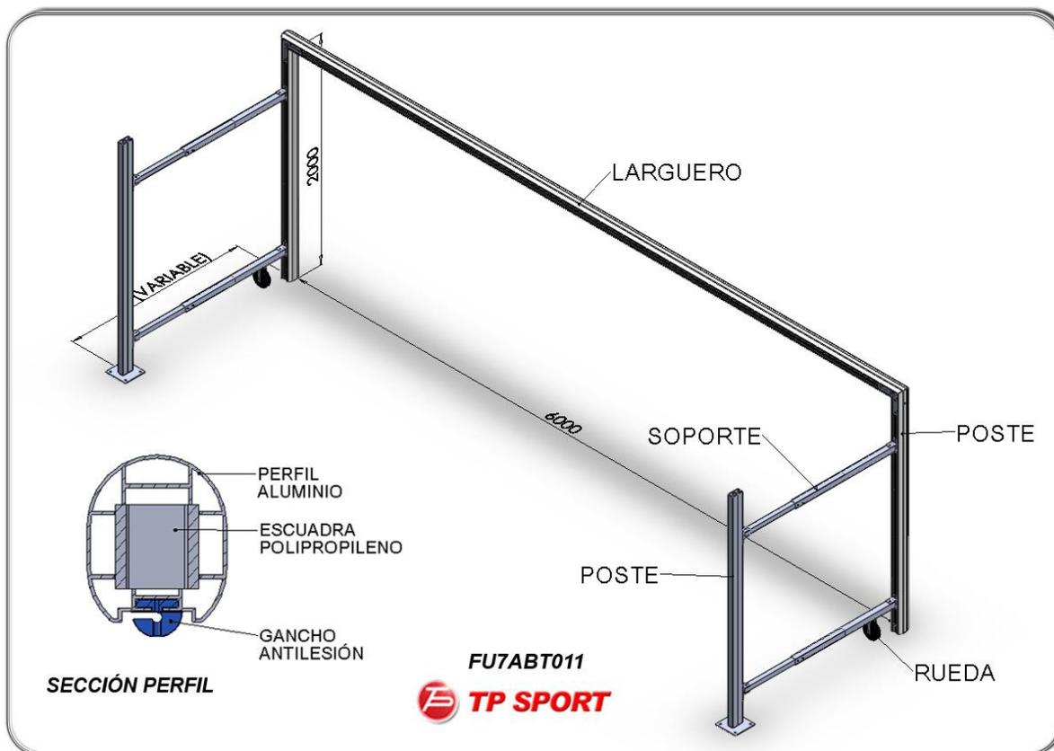
**DETALLE DE LOS COMPONENTES DE LA PORTERÍA**
