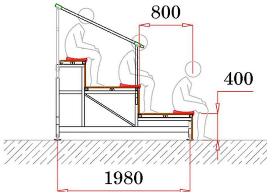
Grada desmontable ensamblada mediante tornillos de acero con plataforma de un mínimo de 800 Mm. preparada para acoplar asientos individuales modelo TP SPORT S-94 SG sobre la plataforma mediante tornillos. Se suministran a obra por piezas y se ensamblan mediante tornillos de acero
