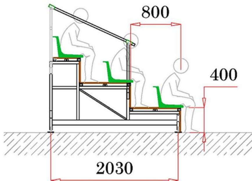
Tribuna fija ensamblada mediante tornillos de acero con plataforma de un mínimo de 800 mm, preparada para acoplar asientos TP SPORT S97-SG sobre la plataforma mediante tornillos. Patas fijadas al suelo para asegurar su compleja fijación.
